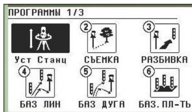
12 сурет – Trimble M3 тахеометрінің негізгі дисплейі
