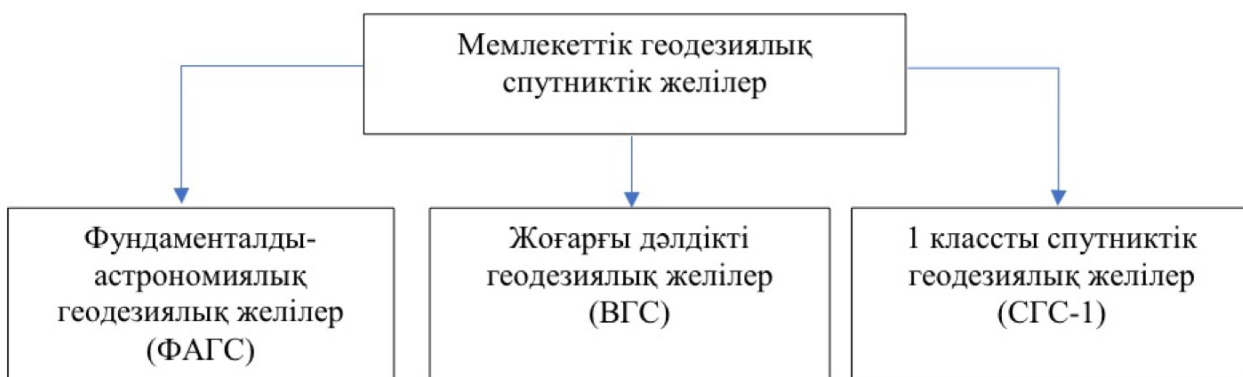
5 – Сызба. Мемлекеттік геодезиялық спутниктік желілердің дәрежесі
